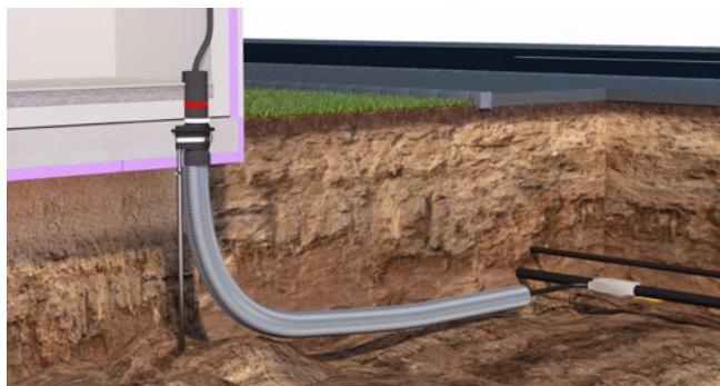
Eingebaute Einsparten-Gebäudeeinführung ESG100 FUBO EBT mit werkseitig verbundenem Leerrohrsystem Hatelflex141110, eingebauter Ringraumdichtung HRK100 SSG 1x18-65 und der Sparte Elektro
