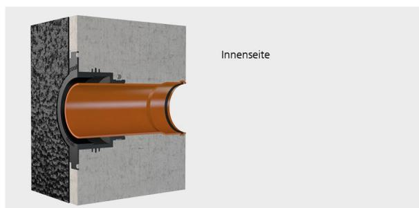
Der integrierte Anarbeitungsflansch ermöglicht eine einfache Anarbeitung von Flächenabdichtungen nach DIN 18533 bis zum Lastfall W2.1-E. Es ist daher keine aufwendige Anarbeitung einer Hohlkehle notwendig.
