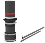
Rohbauteil und Aufstellvorrichtung zum Einbetonieren in die Bodenplatte für nicht unterkellerte Gebäude. Zur kompakten Einführung der Sparten Gas oder Wasser DN 50. Die Hauseinführungskombination HEK und der flexible Spiralschlauch sind nicht im Lieferumfang enthalten.
