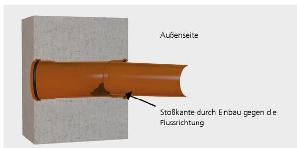
Bei herkömmlichen Wanddurchführungen in Doppelsteckmuffen-Ausführung wird die "Flussrichtung" durch das Einstecken des KG-Rohr-Spitzenendes auf der Gebäudeaußenseite unterbrochen. Dies führt bei leichten Setzungen, die im Bereich des Arbeitsraumes nicht ganz ausgeschlossen werden können, zu einer "Stoßkante". Die Konsequenz: An der Kante bilden sich Ablagerungen, die über einen längeren Zeitraum zur "Verstopfung" des Abwassersystems führen können.
