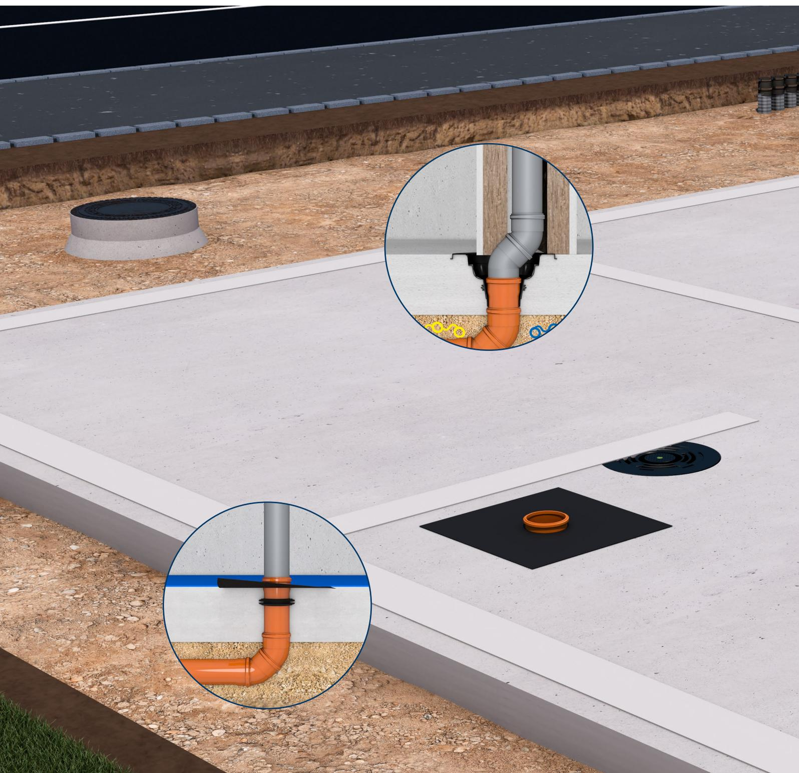
Unsere Produktpalette im Bereich der Futterrohre bietet Ihnen für jede Wandart und jeden Lastfall die passende Lösung. In Kombination mit unseren Ringraumdichtungen bilden sie eine optimale Abdichtlösung zwischen Gebäude und Versorgungsleitung.
