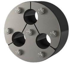
Individuelle Ringraumdichtung in geschlossener oder geteilter Ausführung zur Abdichtung von neu zu installierenden oder bereits verlegten Kabeln. Die Dichtung wird entsprechend kundenspezifischer Maßvorgaben gefertigt - zum Beispiel exzentrisch, mit überdeckendem Flansch oder für Mehrfach- und Mischbelegung.
