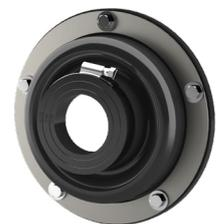
Zum Andübeln vor Kernbohrungen, Durchbrüchen oder Futterrohren an Wänden oder vor Aussparungen an Blechgehäusen. Systembedingt wird die vorhandene Kellerabdichtung ohne aufwändige Nachbearbeitung fachgerecht eingebunden. Gleichzeitig wird mit demselben Bauteil direkt das durchgeführte Medienrohr abgedichtet.
