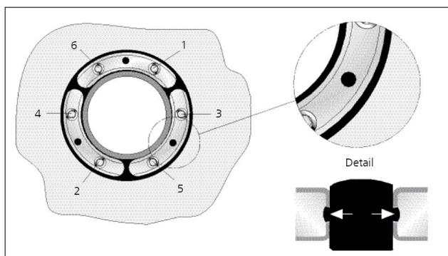
Detailansicht - HSD, Kontrollöffnung und Anzugsreihenfolge der Schrauben
