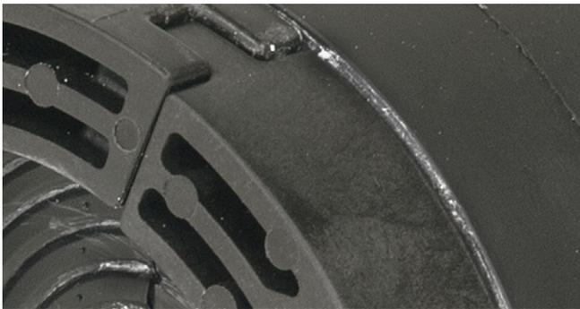
Pressplatten mit Formschlussverbindung
