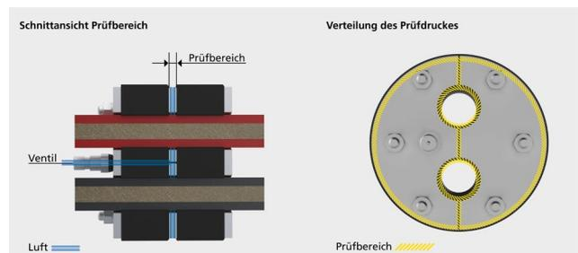
HRD150 PV G in Kernbohrung
