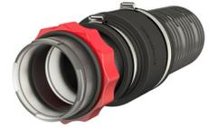
Zum Einsatz in Dichtpackung und Alufansch HSI90. Zur Anbindung von gewellten Kabelschutzrohren. Die Abdichtung erfolgt über die Manschettentechnik, bei der eine Gummimanschette mit Spannbändern auf den Systemdeckel sowie das Schutzrohr gespannt wird.
