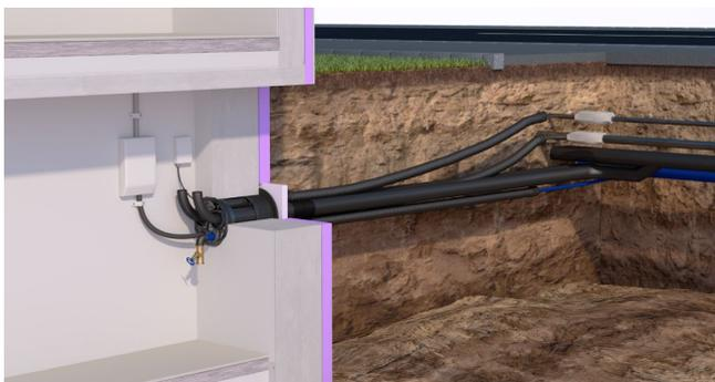
Eingebaute MSH FW Basic Grundvariante 1 mit Außendichtelement MSH FW Basic M6 und MSH FW Basic M2 mit angeschlossenen Leerrohrsystemen und den Sparten Wasser, Elektro, Kommunikation und Fernwärme.
