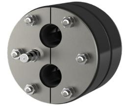
Individuelle Ringraumdichtung mit integriertem Prüfventil zur Überprüfung der Dichtigkeit ohne erhöhten Aufwand direkt nach der Montage und zur einfachen Fehlersuche bei Undichtigkeiten. Erhältlich in geschlossener oder geteilter Ausführung zur Abdichtung von neu zu installierenden oder bereits verlegten Kabeln. Die Dichtung wird entsprechend kundenspezifischer Maßvorgaben gefertigt - zum Beispiel exzentrisch, mit überdeckendem Flansch oder für Mehrfach- und Mischbelegung.
