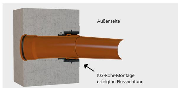
Durch die Konstruktion der UDM erfolgt systembedingt keine Unterbrechung der "Flussrichtung". Beim Auftreten von leichten Setzungen, die im Bereich des Arbeitsraumes nicht ausgeschlossen werden können, entsteht keine "Stoßkante". Die Konsequenz: Es können sich keine Ablagerungen bilden, der Abfluss wird in seiner Funktion nicht beeinträchtigt.
