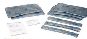
Gas- und wasserdichtes Brandschott entsprechend der Feuerwiderstandsklasse S90 nach DIN 4102-9 zum Einbau in das System HSI150 für Wände. Die Abdichtung erfolgt über die Ringraumdichtung HRD. Das Schott ist für Kabel aller Art in Wänden zugelassen.
