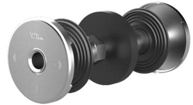
Für den Einbau im Fertigteilwerk, gewährleistet eine zuverlässige Abdichtung zum Fertigteil und zum Ortbeton. Über das beidseitige Gewinde im Leiterkern können Erdungsanschlüsse vorgenommen werden.
