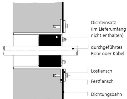
D1: Futterrohr  $\varnothing$ 1, D2: Festflansch  $\varnothing$ a, D3: Losflansch  $\varnothing$ a
