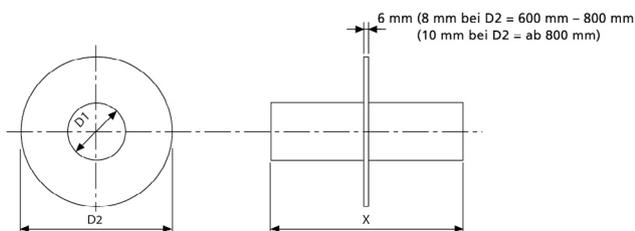
D1: Futterrohr  $\varnothing i$ , D2: Flanschaußenmaß
