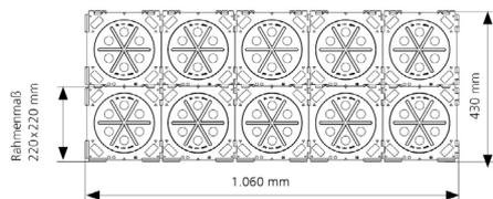
Bestellbeispiel als Paket 2x5 für Wandstärke 200 mm. Best.-Bez.: HSI150 2x5 K/200 (Einfach-Dichtpackung) oder HSI150 2x5 K2/200 (Doppel-Dichtpackung)
