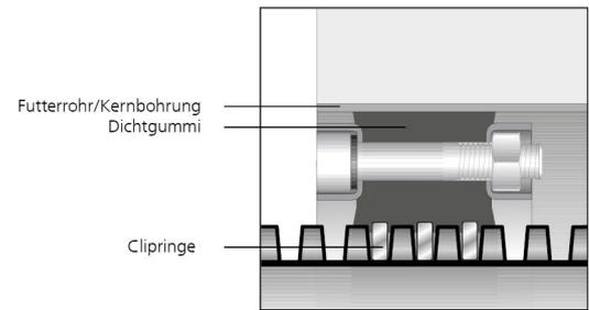
Schnittzeichnung: Positionierung in der Bohrung
