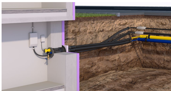
Eingebaute MSH PolySafe Grundvariante 1 mit Außendichteelement MSH PolySafe M6.2 mit angeschlossenem Leerrohrsystem und den Sparten Wasser, Elektro, Kommunikation und Gas.
