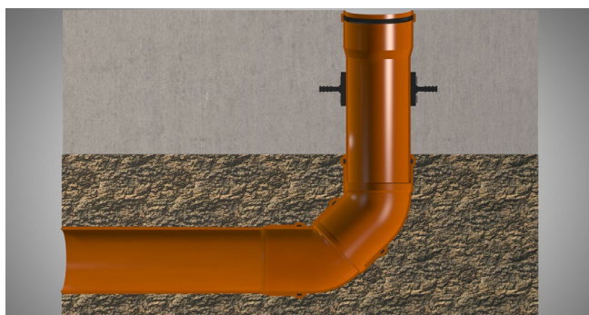
HMK eingebaut in Bodenplatte zur Abdichtung eines Abwasserrohres
