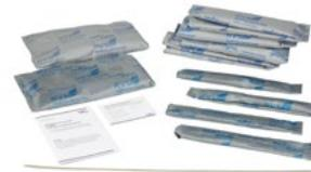
Gas- und wasserdichtes Brandschott entsprechend der Feuerwiderstandsklasse S90 nach DIN 4102-9 zum Einbau in das System HSI150 für Wände. Die Abdichtung erfolgt über Systemdeckel. Das Schott ist für Kabel aller Art in Wänden zugelassen.
