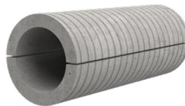
Bestehend aus zwei Halbschalen zur nachträglichen Abdichtung von bereits verlegten Medienleitungen. Zum Einbetonieren oder Einmörteln. Umlaufende Außenrillung gewährleistet einen dichten und kraftschlüssigen Verbund mit der Wand.
