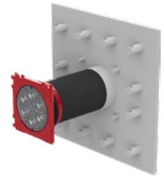
Zur Einführung von Kabeln bzw. Anbindung von Kabelschutzrohren in Gebäude mit Dichtbahnen oder zugelassenen kunststoffmodifizierten Dickbeschichtungen (PMBC). Mit der Fest-/Losflansch-Konstruktion wird ein Übergang von der Gebäudeabdichtung zur Durchführung hergestellt. Die Abdichtung erfolgt nach DIN 18533 (schwarze Wanne).
