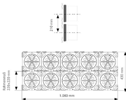
Bestellbeispiel als Paket 2x5 für Wandstärke 200 mm. Best.-Bez.: HSI150 2x5 K/200 (Einfach-Dichtpackung) oder HSI150 2x5 K2/200 (Doppel-Dichtpackung)
