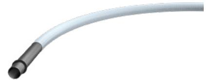
Für Ein- und Mehrspartenhauseinführungen zur Erstellung eines durchgängigen Schutzrohrsystems bis zu den Hauptversorgungsleitungen. Angeschweißtes Mantelrohr mit 3-Stegdichtung zum Anschluss an Grundkörper der Hauseinführung für Gebäude ohne Keller.
