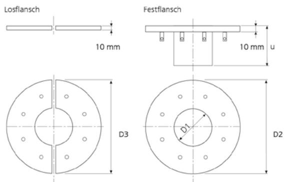
D1: Futterrohr  $\varnothing$ 1, D2: Festflansch  $\varnothing$ 2, D3: Losflansch  $\varnothing$ 3
