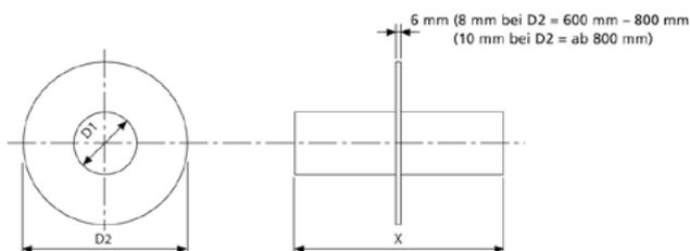
D1: Futterrohr  $\text{Ø}i$ , D2: Flanschaußenmaß
