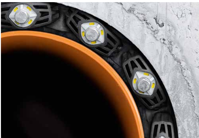
GKD fertig montiert – alle Sichtfenster sind komplett gelb ausgefüllt.
