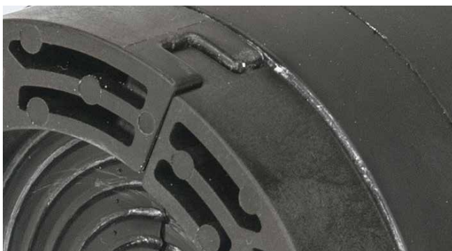
Pressplatten mit Formschlussverbindung
