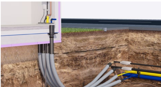
Eingebaute Mehrsparten-Hauseinführung MSH Basic FUBO SR4 EBT mit Dichteinsatz MSH Basic MBK R4, Leerrohrsystem Hateflex14078 MRD/x und den Sparten Wasser, Elektro, Kommunikation und Gas
