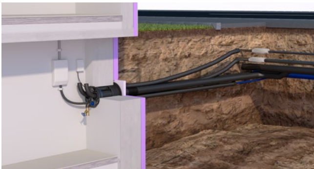
Eingebaute MSH FW Basic Grundvariante 1 mit Außendichtelement MSH FW Basic M6 und MSH FW Basic M2 mit angeschlossenen Leerrohrsystemen und den Sparten Wasser, Elektro, Kommunikation und Fernwärme.
