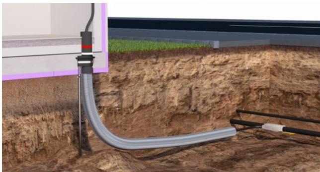
Eingebaute Einsparten-Gebäudeeinführung ESG100 FUBO EBT mit werkseitig verbundenem Leerrohrsystem Hateflex14110, eingebauter Ringraumdichtung HRK100 SSG 1x18-65 und der Sparte Elektro
