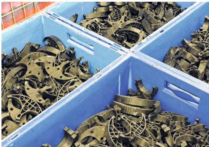
Kurz vor der Fertigstellung: Pressplatten aus Hochleistungskunststoff warten auf ihre Anwendung.
