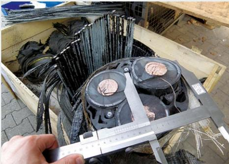
**Seekabel mit sehr großen Durchmessern – typisch für Offshore-Anwendungen.**
