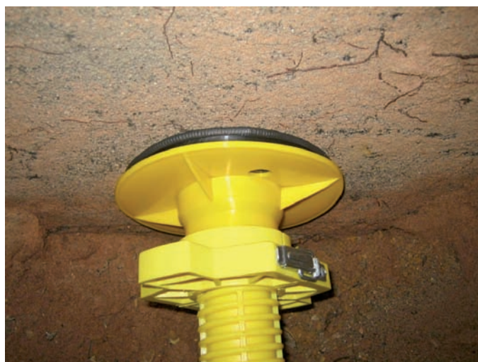
Bild 5: Standardverspannvorrichtung zur Fixierung des MIS
