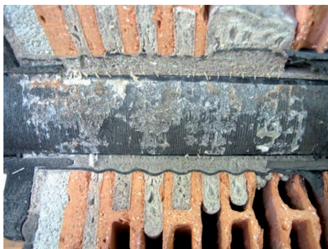
Bild 9: Positiver Einbauversuch im Porotonstein (Hauseinführung Fa. RMA)
