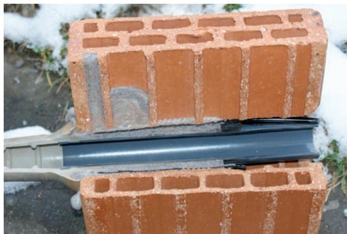
**Bild 17:** Probeeinbau – Expansionsharz in Kernbohrung
