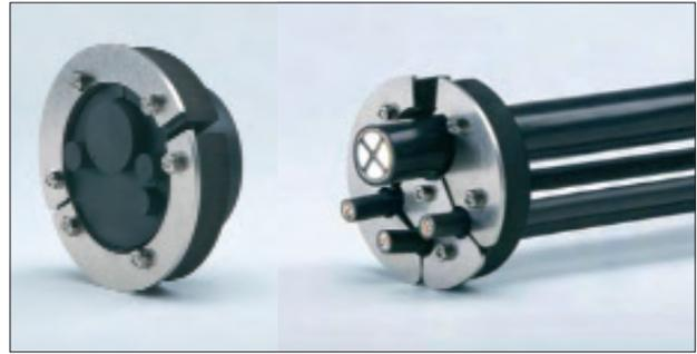
**Bild 8:** Pressdichtungseinsätze für HSI 150, links: Wechseleinsatztechnik (WE), 110 mm, rechts: Geteilte Einsatztechnik (G), 160 mm
