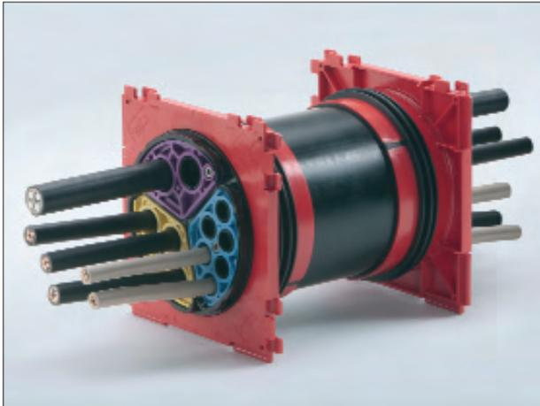
**Bild 7:** Einsatz des Segmento-Systems für bis zu 24 Kabel mit je max. 15 mm Durchmesser bei Wasserdichtigkeit bis 5 m Wassersäule, Foto: Hauff-Technik
