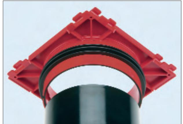
*Bild 3: Dichtpackung HSI 150 mit Dreisteg-Dichtung, weiterentwickeltem Montagerahmen (größerer Flansch, neue Nut-Feder-Technik) und neuer Dichtlippe am Innenradius für Rohrteile zur Wandstärkenanpassung als Einbetoniererteil*
