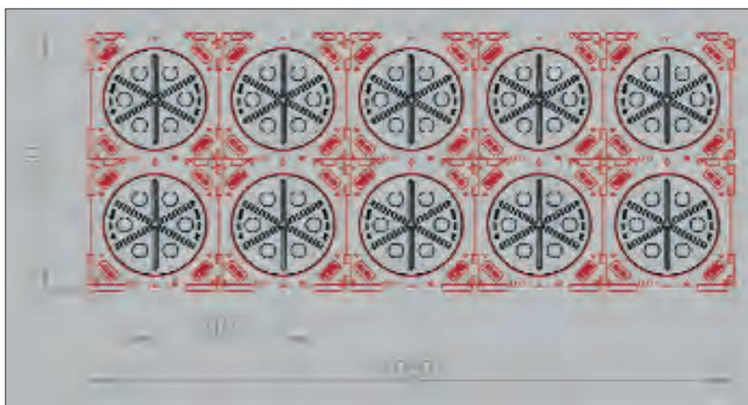
**Bild 6:** Abmessungen eines HSI 150 – Kabeldurchführungspaketes, bestehend aus 2 × 5 Dichtpackungen: Bezeichnung: HSI 150-2×5-K2/x, hier: vergrößerte Abstände, dickere Betonstege
