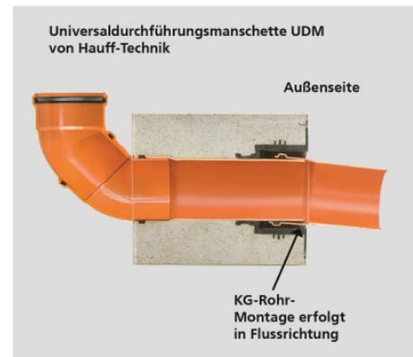
Nicht wasserdichte Bauwerke müssen zusätzlich mit Hautabdichtungen nach DIN 18195 versehen werden. Diese muss im Bereich der Leitungsdurchdringungen nachträglich wieder mit eingebunden werden. Herkömmliche Abwasserdurchführungen bieten hier keine Anschlusslösung. Der integrierte Anspachtelflansch der UDM ermöglicht eine einfache Anarbeitung von Flächenabdichtungen in Anlehnung an DIN 18195 Teil 4. Es ist daher keine aufwendige Anarbeitung einer Hohlkehle oder ein zusätzliches Bauteil notwendig.
