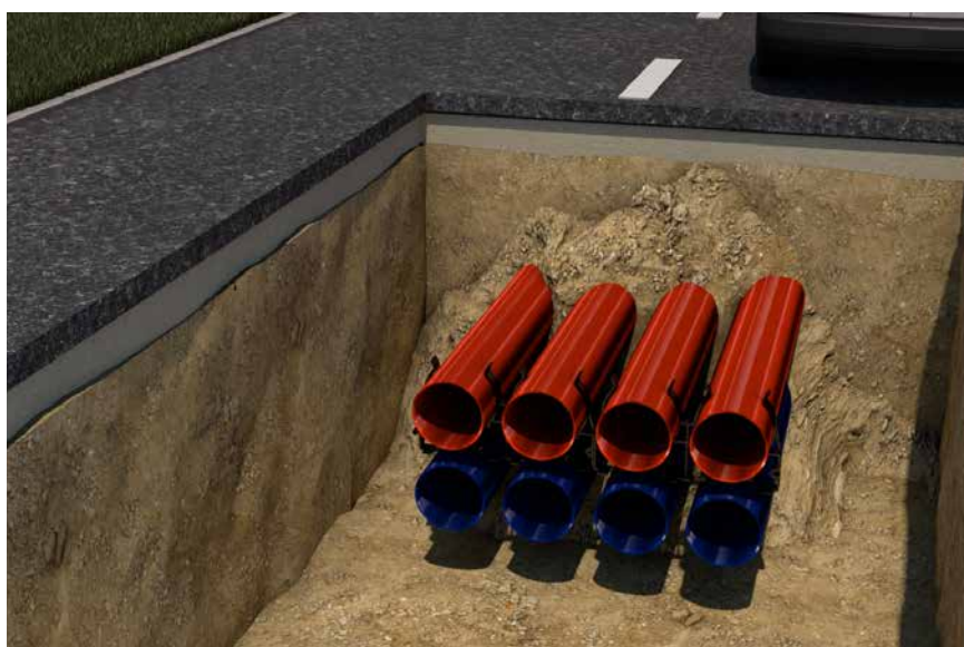
Minimalna głębokość ułożenia węży ochronnych kabli przy ruchu transportu ciężkiego SLW60
