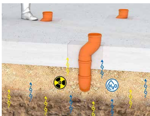
Achtung: keine dichte Verbindung zwischen Rechteckaussparung und Beton und zwischen KG-Rohr und Beton
